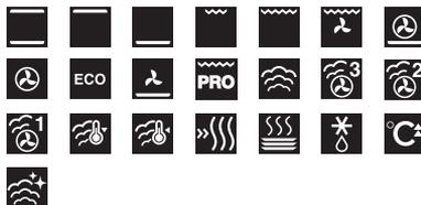
Resistenza superiore e inferiore, Resistenza superiore, Resistenza inferiore, Grill, Grill grande, Grill ventilato, Aria calda 3D e riscaldamento inferiore, Aria calda 3D, Aria calda 3D ECO, Riscaldamento inferiore ventilato, Pro Roast (Auto Roast), Cottura a vapore a 100°C, Aria calda 3D con vapore (tre intensità), Cottura a vapore a bassa temperatura, Cottura a vapore sottovuoto, Scaldavivande, Scaldastoviglie, Scongellamento, Preriscaldamento rapido, Pulizia a vapore SteamClean
