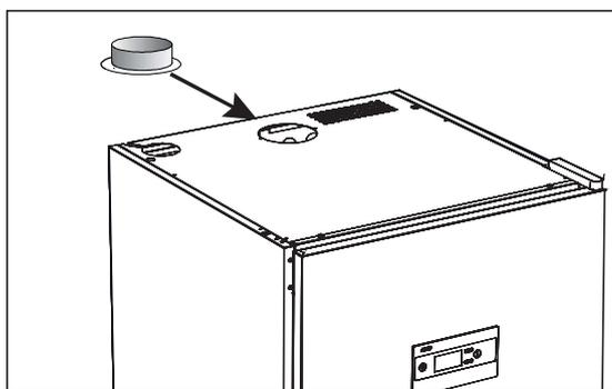
Posizionare la flangia di collegamento in dotazione sopra il foro nella parte superiore dell'armadio, inserire le viti e fissare la flangia.
