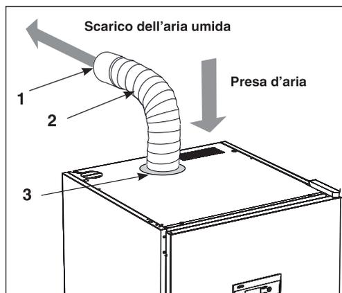
Se l'armadio è collegato in modo permanente ad un condotto di ventilazione, l'intero spazio dove si trova l'armadio sarà ventilato tramite l'armadio asciugabiancheria.
