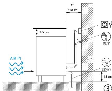
Avløpsrøret skal ha en innvendig diameter på 30 mm. og med en minimum skråning på 3 cm. per meter. (Se figur).
