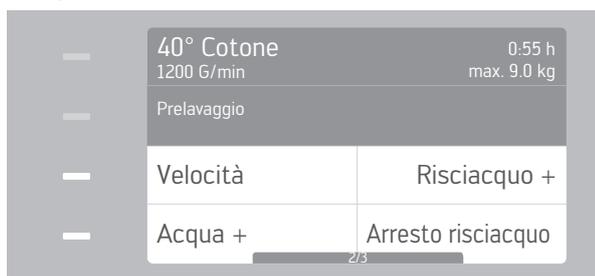
Toccando con il dito la barra luminosa accanto a **Velocità**, è possibile diminuire il numero di giri in intervalli di 100 G/min. A 0 G/min la lavatrice non effettua la centrifuga ed è possibile estrarre la biancheria bagnata non strizzata.
