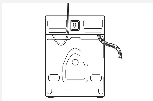
Utilizzare esclusivamente il tubo flessibile fornito con la macchina. Non riutilizzare tubi vecchi o altri tubi flessibili allentati.
